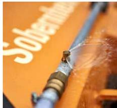
Wassersprüheinrichtung mit/ohne Wassertank
