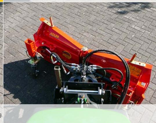
Alle Räummöglichkeiten in V-, Y- und Diagonalstellung
