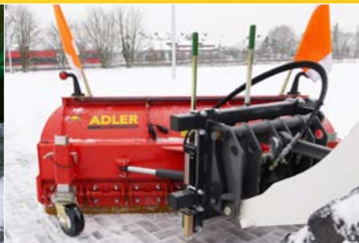
Universalaufnahme mit hydraulischer Verschwenkung (mit zwei Hydraulikzylindern)
