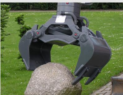
Vielfältig einsetzbarer Greifer für unterschiedlichste Einsätze und Handling verschiedenster Materialien, wie z. B. Stein- Setarbeiten, Sortierung von Bauschutt, Verladung und Sortierung von Recyclingmaterialien, Erdaushub und Verladung von grobem Schüttgut, Busch- und Strauchwerkverladung.
