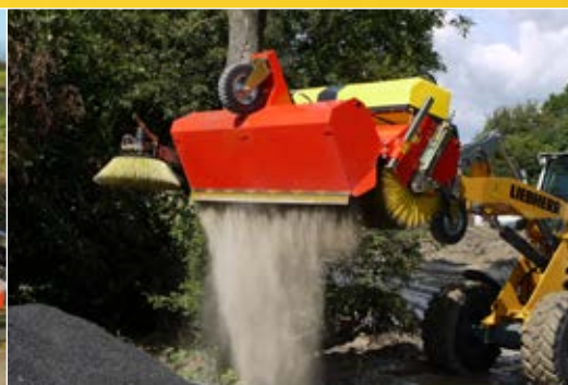
Hydraulische Entleerung des Sammelbehälters
