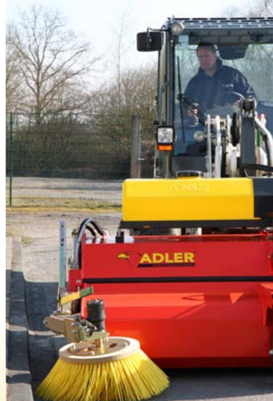
Seitenkehrbesen und Wassertank 240 l als Option
