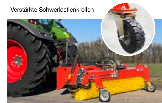
Dreipunktanschluss für Heck- und Frontanbau
