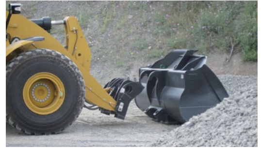
Aufhängungen für Fusion-Schnellwechsler oder Bolzenanbau.
