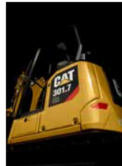
301.7 CR – nur offener Fahrstand mit Schutzdach, Kurzheck
